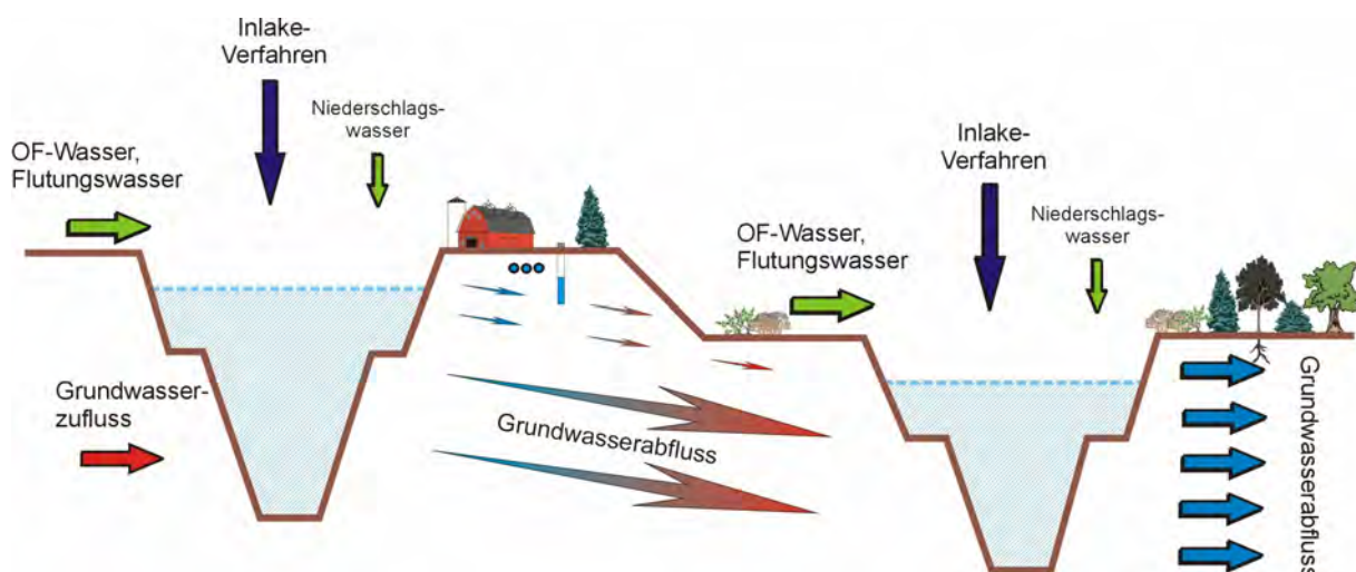
Abb. 7: Herstellung von Reaktiven Seewänden gegen GW-Versauerung: Gegenwärtiger Zustand.
