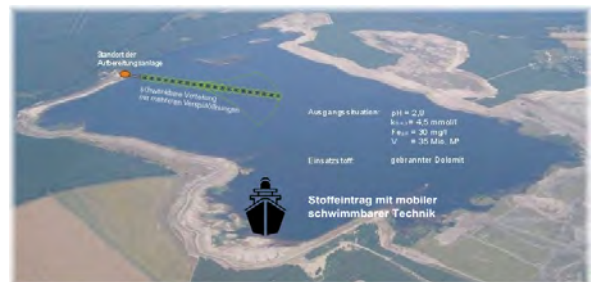
Abb. 4: Anpassung der Inlake-Technologie an unterschiedliche Seetypen durch mobile Technik (Ufertechnologie mit Suspensionsverteilung, fahrbare Silo- und Verteiltechnik).
